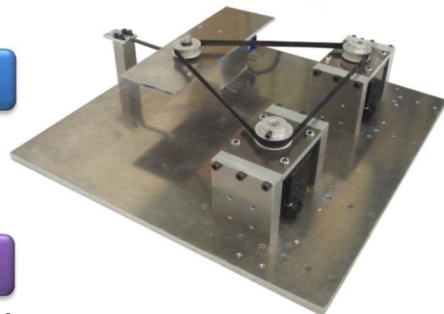
張力・速度制御システム
