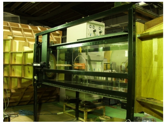
変動を模擬した翼型試験用風洞
