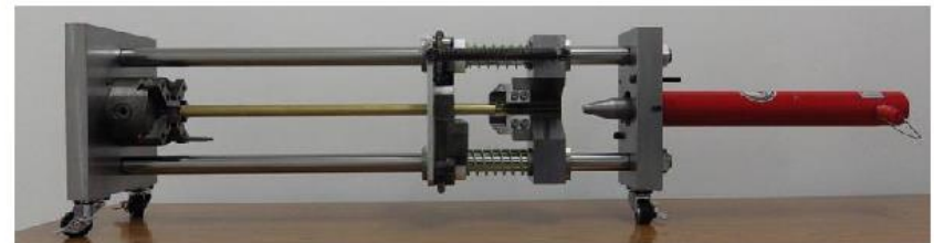
試作した長尺配管用軸方向切断装置
