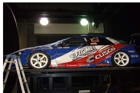
サイバークーの風洞実験状況
