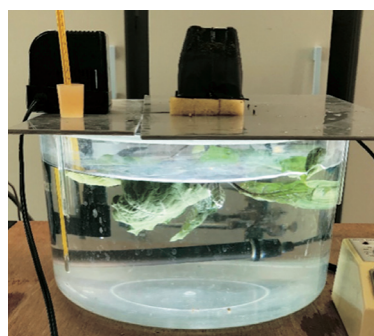
キュウリ葉への短期的な 高温ストレス処理方法の様子
