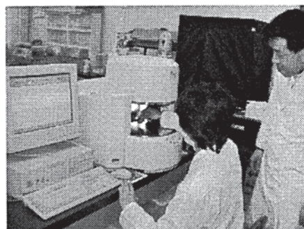
トマト果実の蛍光 X 線分光解析を行い、陽イオンの分布を計測しているところ
