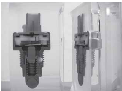
ウォータージェットによる断面カットサンプル
