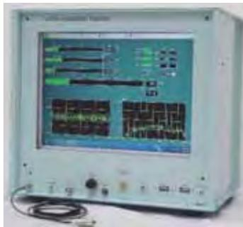
ベアリング等で発生した微小な振動/音響信号を圧電型検知センサーで捕捉し、FFT機能を活用し実時間で周波数帯別に分け、各強度レベルを基準値（規格値）と比較することで異常有無を判定します。
