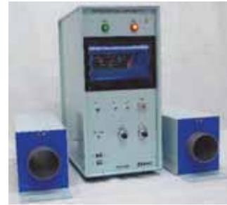
▽渦電流の変化を利用した非破壊検査方式を採用
