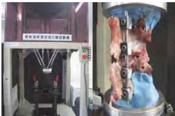
≪写真1:工学部にある6軸材料試験機(左)とバイオメカニクス実験(右)≫
