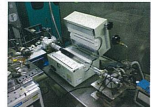
熱CVD装置 (カーボンナノチューブ成長装置)
