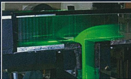
レーザーによる速度場・濃度場計測
