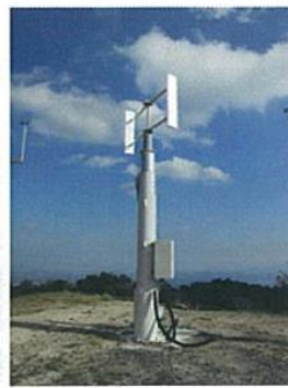
垂直軸風車翼の実験
