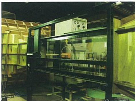
変動を模擬した翼型試験用風洞
