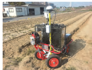
《作業者行動追跡機能を持つ農業用ロボット車両》
