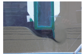
模型実験での堰基礎で生じる浸透破壊
